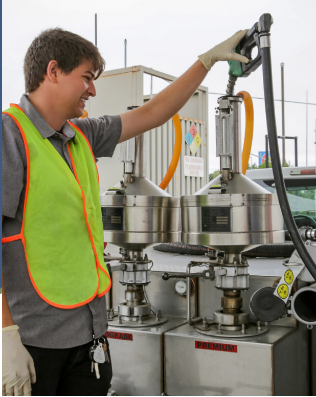
Un inspector verifica la precisión del medidor de combustible (bomba de gasolina).
