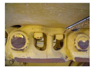
Notes - UNDERCARRIAGE 1 WITH CAT NUMBER LOOK LIKE WORN ABOUT 20% RAILS,PADS,ROLLER CARRIES & SPROCKETS. ROCK GUARD ON BOTTOM ROLLERS.
