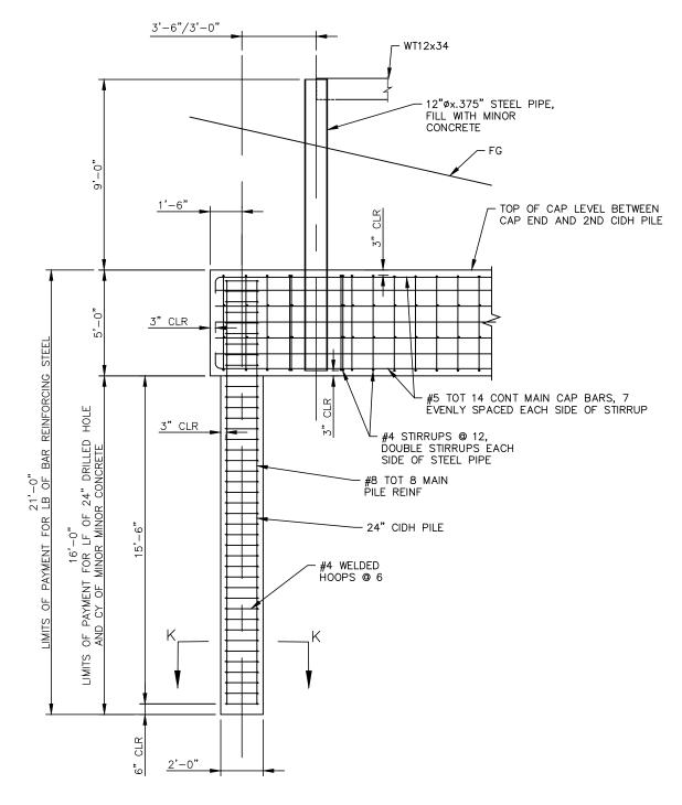
PART ELEVATION - UPPER DEBRIS RACKS
